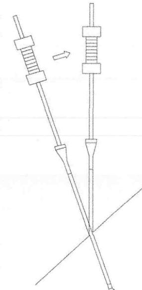
直すとロッドの継ぎ目が折れる。
