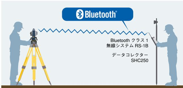
Bluetooth®クラス1無線を搭載し、電子野帳との安定した無線接続が行えます。
