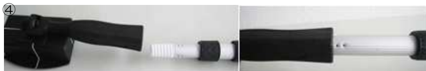
④プロブアダプタと延長棒の取り付け(延長棒を右回して取り付けます)
