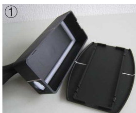
①プロブアダプタを開き,プロブをセットします
