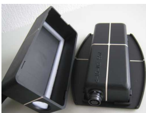
①プロブアダプタを開き,プロブをセットします
