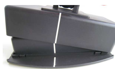
②プロブ信号コネクタをアダプタの丸穴へ入れます(白いセンターラインを合わせます)
