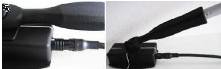
⑤プロブ信号コネクタへ信号ケーブルコネクタを合わせて「カチッ」と入るまで押し込みます(本体側の接続も同様に行ってください)
